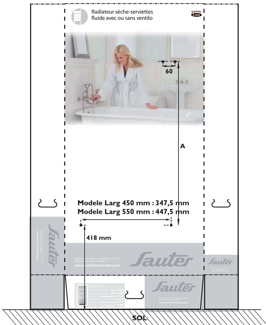
**3** Enlevez le couvercle. Avec un crayon, dessinez une croix de 4 mm de large afin de la visualiser lorsque vous aurez installé les crochets à l'étape 4. Percez les 4 trous et mettez des chevilles. En cas de support particulier, utilisez des chevilles adaptées (ex : plaque de plâtre).
