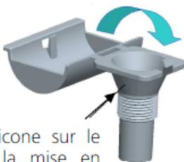
4 Placer du silicone sur le cône avant la mise en place
