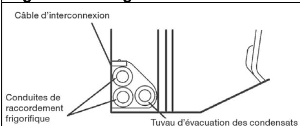
**Fig. 30 sortie arrière gauche**
