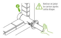
Tenir fermement le rebord du conduit contre le mur. Tirer la cordelette pour que le joint soit plaqué contre le mur.
