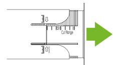
Regarder à l'intérieur du conduit et vérifier que les 2 flèches soient orientées vers le haut et alignées.
