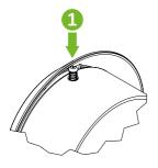
6 Tout en maintenant les goupilles enfoncées, retourner le joint vers l'intérieur du tube et pousser l'ensemble grille et joint à l'intérieur du tube.
