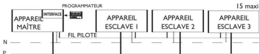
L'occupation des pièces étant différente le jour et la nuit, on est amené à créer une zone jour (par exemple, l'appareil maître sera dans le séjour et pilotera les appareils esclaves dans la salle à manger, la cuisine et l'entrée) et une zone nuit (par exemple, l'appareil maître sera dans la chambre des parents et pilotera les appareils esclaves dans la chambre des enfants).
