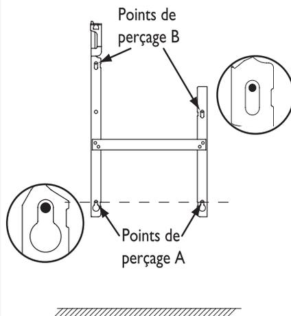
Les points de perçage **A** donnent la position des fixations inférieures.
