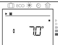
La température Hors Gel est réglée à 7° C ( $\pm 3^\circ$  C) et ne peut pas être modifiée.
