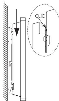
Pour déverrouiller l'appareil de la patte d'accrochage, munissez-vous d'un tournevis plat et poussez la languette vers le mur. Soulevez l'appareil tout en maintenant la languette avec le tournevis. Basculez-le en avant puis retirez-le des supports **S1**.
