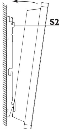
Abaissez l'appareil sur la patte d'accrochage. Un clic vous indique que l'appareil est fixé et verrouillé.
