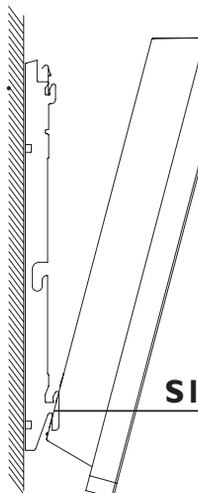
Faites basculer l'appareil en le soulevant pour le poser sur les supports **S2**.
