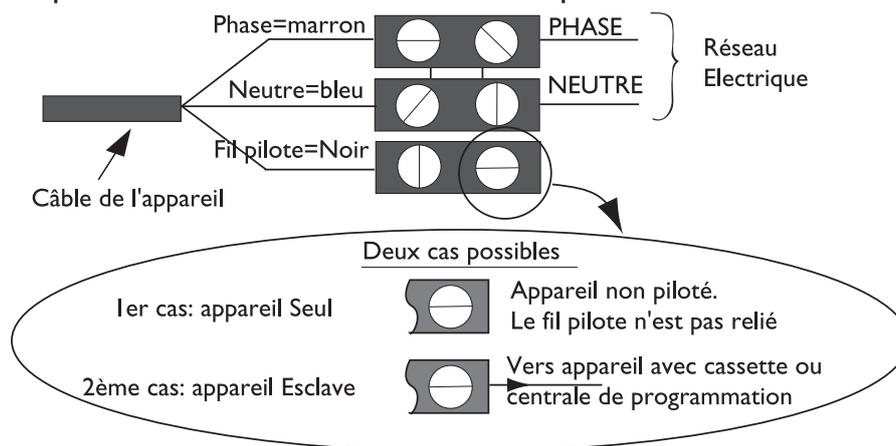
Vous pouvez raccorder le fil pilote si votre maison est équipée d'une centrale de programmation, d'un programmateur ou d'un gestionnaire. Dans ce cas, pour vérifier la transmission correcte des ordres de programmation, procédez aux vérifications suivantes en fonction des modes choisis (*Confort, Eco, ...*) :
