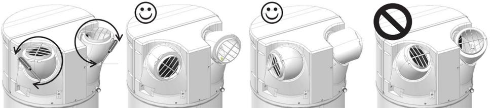
❶ Dévisser les vis de blocage des bouches puis les orienter dans la direction choisie en effectuant un mouvement de rotation
