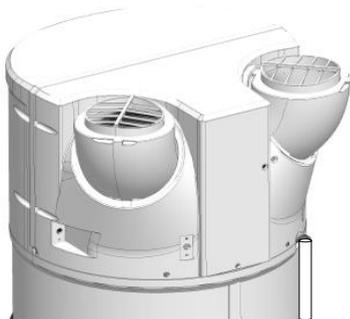
Selon l'humidité de l'air, il peut se former **jusqu'à 0,5l/h de condensats**. L'écoulement de ces condensats ne doit pas être réalisé de manière directe à l'égout, car les vapeurs d'ammoniac qui refoulent de l'égout pourraient endommager les lamelles de l'échangeur et les pièces de la pompe à chaleur.
